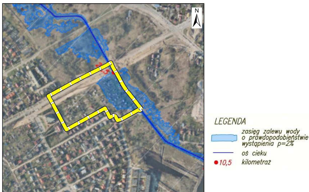
Rysunek 5 Zalew doliny od ul. Ciołkowskiego (km 20+462) do ul. Dojlidy Fabryczne (km 21+724) źródło: Opracowano na podst. Koncepcji uregulowania przepływu wód w rzece Białej. Ekspertyza hydrotechniczna na odcinku od ul. Plażowej do granic miasta Białegostoku w rejonie oczyszczalni ścieków (2017)
