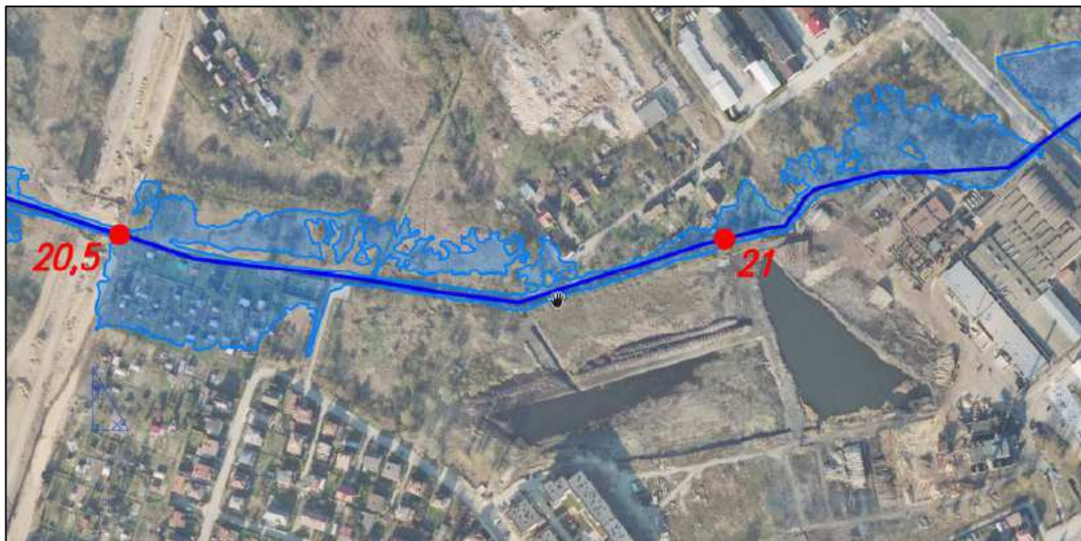
Rysunek 5 Zalewy doliny od ul. Ciołkowskiego (km 20+462) do ul. Dojlidy Fabryczna (km 21+724) źródło: Koncepcja uregulowania przepływu wód w rzece Białej. Ekspertyza hydrotechniczna na odcinku od ul. Plażowej do granic miasta Białegostoku w rejonie oczyszczalni ścieków (2017)
