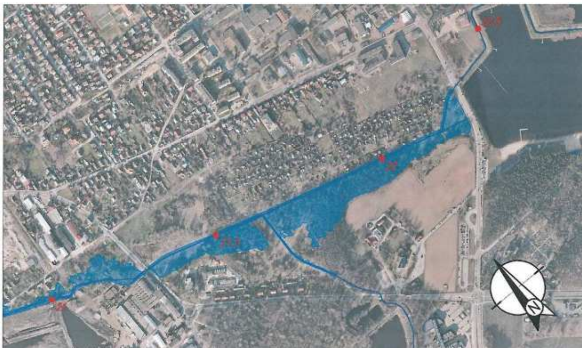
Rysunek 7 Zasięg zalewu wody o prawdopodobieństwie wystąpienia p = 2\% odcinek rzeki pomiędzy ulicami Dojlidy Fabryczne i Płażową - stan po wykonaniu grobli wzdłuż prawego brzegu rzeki Białej
